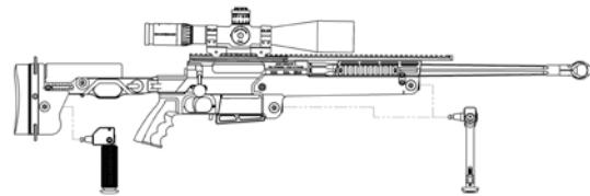
BIPIED + BÉQUILLE MODULABLES - ADJUSTABLE BIPOD + MONOPOD
