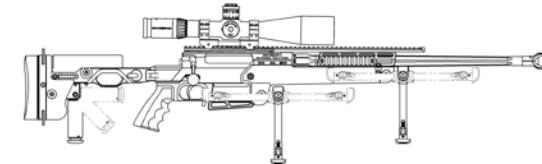
BIPIED + BÉQUILLE PLIABLES - FOLDING BIPOD + MONOPOD
